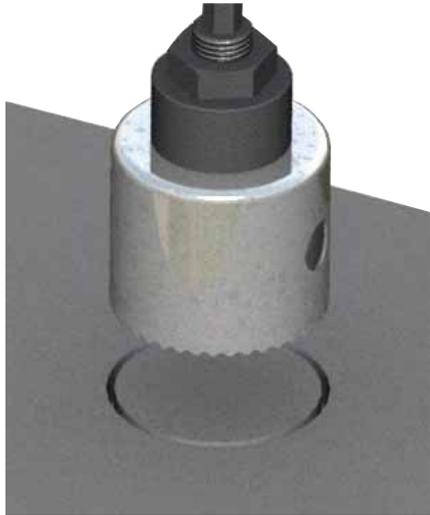
要划割厚度低于0.5 mm (20 mils)的涂层，锻模用胶固定好以后，环绕锻模仔细切割，尖刀就可以做到。
