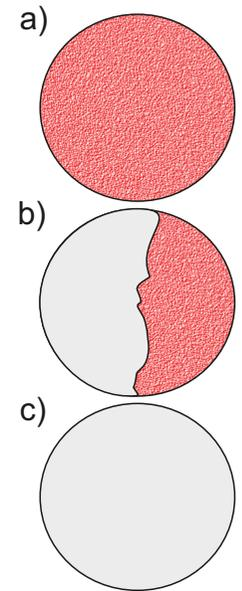
コンクリート面の塗膜を試験している場合は、塗膜とコンクリート間の付着力の方が、コンクリート自体の強度より大きいことがよくあります。この場合は、コンクリートが破れてドリーの底面に付いています。
