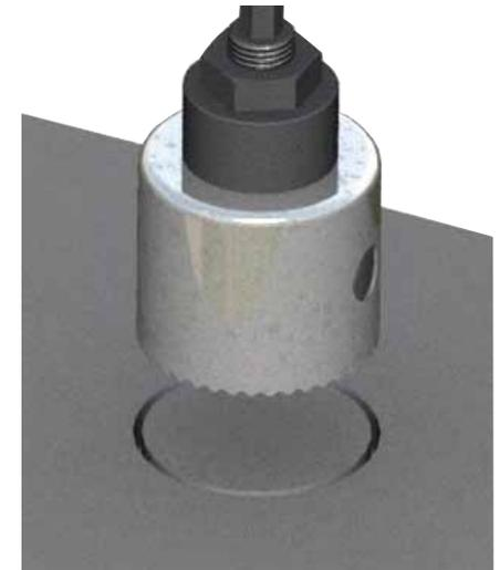
Pour découper des revêtements dont l'épaisseur est inférieure à 0.5 mm (20 mils), un couteau pointu est parfois suffisant pour réaliser une découpe soignée autour du plot une fois celui-ci solidement collé.
