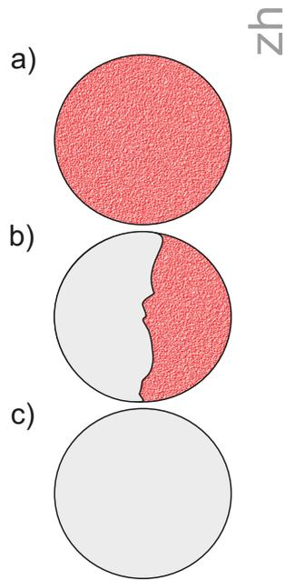
当在混凝土上测试时，涂层和混凝土之间的胶粘力通常都会大于混凝土内部的凝固力。这种情况下，混凝土会从表面上脱落下来，在锻模面上的涂层上可以看到。
