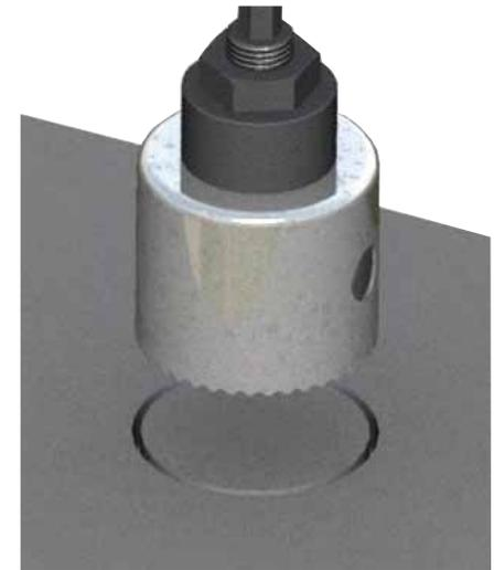
Zum Anreißen von weniger als 0,5mm (20 mil) dicken Beschichtungen kann ein scharfes Messer zum vorsichtigen Anreißen um den Stempel herum ausreichen, nachdem er durch Klebstoff in Position gehalten wird.
