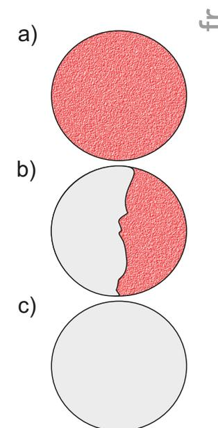
Lors de tests sur béton, il arrive fréquemment que le collage entre le revêtement et le béton dépasse la résistance du béton lui-même. Dans ce cas, le béton est arraché de la surface et se retrouve sur le revêtement situé sur la face du plot.
