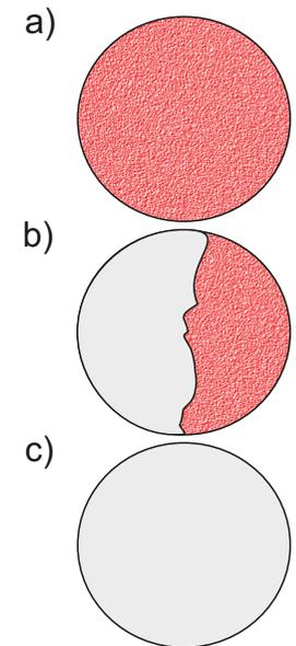
Bij tests op beton is het normaal dat de hechting tussen de coating en het beton de sterkte van het beton zelf overschrijdt. In zo'n geval zult u betonresten aantreffen op de coating onder de dolly.
