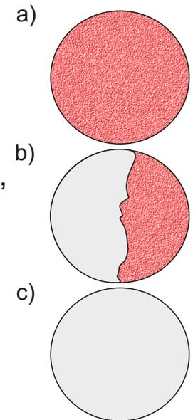
Bei der Prüfung von Beschichtungen auf Beton kommt es häufig vor, dass die Haftkraft zwischen der Beschichtung und dem Beton größer als die Zugfestigkeit des Betons selbst ist. In diesem Fall wird Beton von der Oberfläche abgehoben und ist auf der Beschichtung an der Stempelstirnfläche sichtbar.
